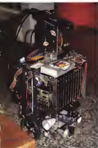
Foto 4. - Questo esemplare ha invece un elevato grado di «intelligenza». È dotato di un sofisticato sistema di comunicazione e di un complesso sistema di sensori e trasduttori. Inoltre è possibile una navigazione tramite mappe o l'acquisizione delle posizioni degli oggetti nell'area di lavoro allo scopo di crearne una base automaticamente «robot esploratore».
